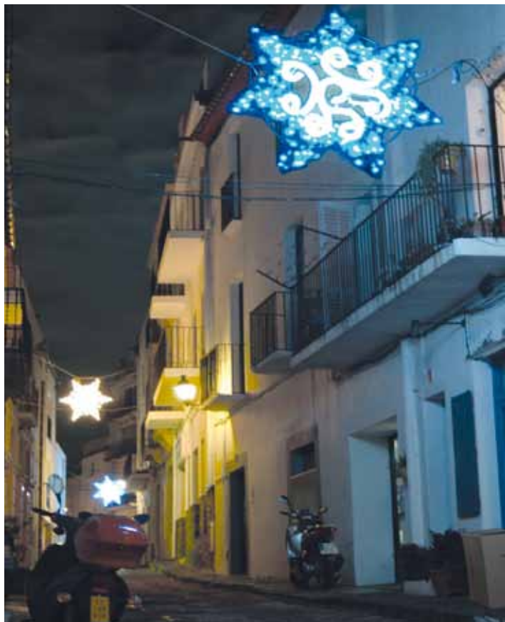
Montaje atirantado en medio de una calle de ancho medio Muntatge atirantat al mig d'un carrer d'ample mig Foto: Provincia de Girona
